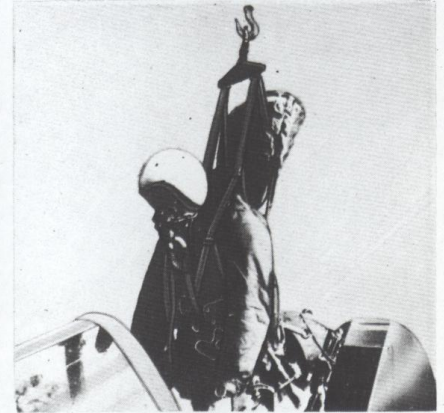
Fig.6 - Dégagement du pilote à l'aide du palan
